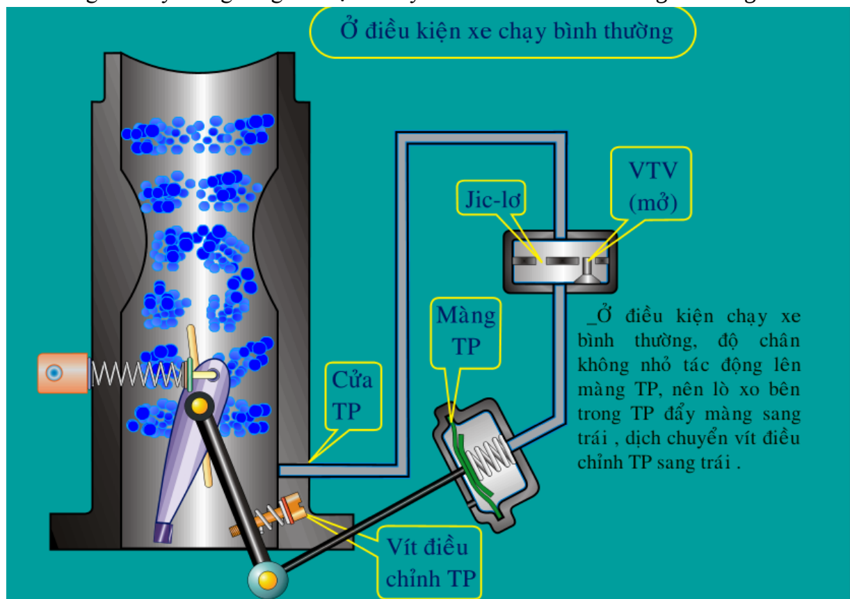
Hình 3. 12 Hệ thống điều khiển bướm ga
